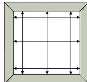
Les coulisses doivent être fixées de façon parfaitement parallèle sur la hauteur et parfaitement alignées sur la largeur. Si ce n'est pas le cas, un calage est nécessaire.
